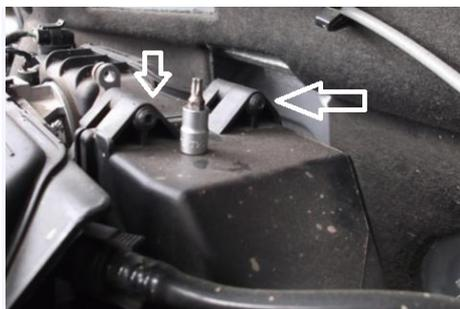
2. Выкручиваем два винта крепления впускного ресивера.
