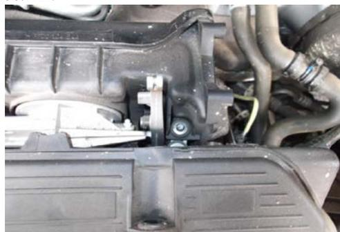
3. Снимаем шланг и отключаем колодку датчика
