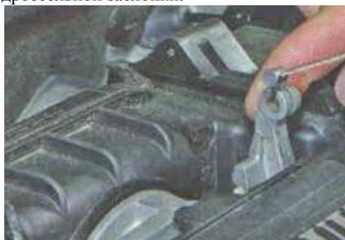
5. Снимаем корпус с дроссельного устройства
