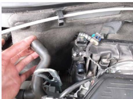
4. Отсоедините от рычага наконечник троса привода дроссельной заслонки.
