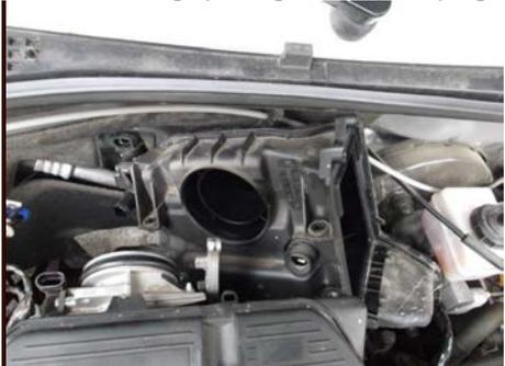
6. Головкой на 8 выверните 2 болта крепления дроссельного узла(находятся внизу) и отведите его в сторону
