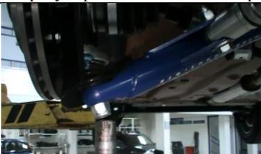
Окончательную затяжку гаек - M 24 с моментом 18кг\м, M30 с моментом 20кгс\м, M16 на растяжке 16,0 – 18,0 кгс/м, производить при поджатом рычаге, например гидравлической стойкой
