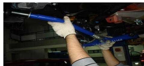
Устанавливаем рычаги от Автопродукт на место штатных в обратном порядке и наживляем все болты и гайки.
