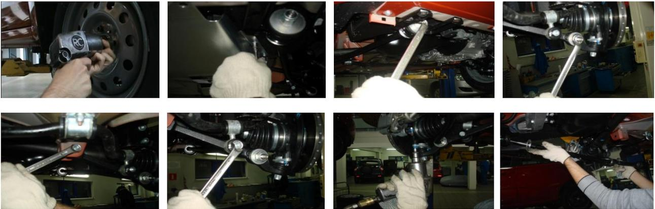
Снять колесо. Произвести демонтаж брызговика двигателя. Открутить гайки M16 крепления растяжки, болты крепления передних кронштейнов, гайки крепления рычага к кузову и вынуть болты M12.
