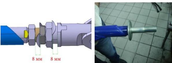
В состоянии поставки свободная часть левой и правой резьбы составляет 8 мм, что соответствует кастору более 2 градусов. Регулировочные шайбы не устанавливать, так как регулировка есть на самом рычаге!
