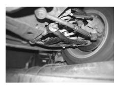
Установку тяг рулевого управления производить в порядке, обратном снятию. Все гайки зашплинтовать.
