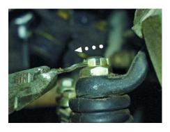
Снять передние колеса, расшплинтовать гайку пальца наружного шарнира.
