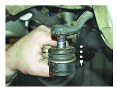
Вывести палец из отверстия рычага. Отсоединить палец внутреннего шарнира тяги тем же способом.
