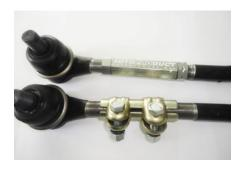
Произвести сборку рулевых наконечников с муфтами в боковые тяги, сравнивая длину и угол разворота с боковыми тягами, которые сняли с автомобиля. Затянуть контргайки муфты на тягах.
