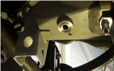
В базовое отверстие необходимо установить штифт.
