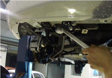
Открутить болты крепления передних кронштейнов
