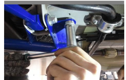
Отверстия заднего кронштейна совпадают с отверстиями кронштейна на кузове. После этого необходимо вставить рычаг в кронштейн и ввести болт сквозь кронштейн и рычаг так, чтобы шляпка болта была спереди! Наживите гайку. Справа следует аккуратно поддомкратить колесо, привод освободит доступ к кронштейну. После этого наживите и затянуть болт с шайбой (поставляется в комплекте) к штифту, установленному в базовом отверстии кузова.
