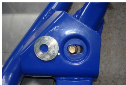
Схема регулировки развала и схождения остается серийной, схождение регулировкой длины тяг рулевого механизма, развал вращением эксцентрикового болта крепления кулака к стойке. Кастор регулируется подбором шайб из комплекта, причем верхняя и нижняя шайбы одной стороны должны быть одинаковы.
