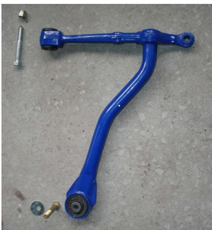
Завести переднюю часть рычага между горизонтальными полками кронштейна переднего, вставить болт вертикально. Задняя часть рычага устанавливается подобно серийному.
