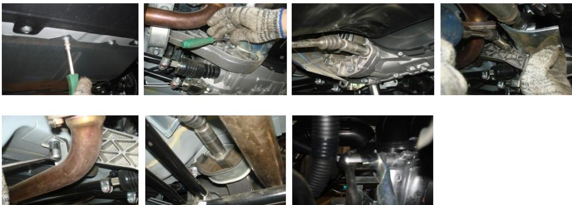
Снять брызговик двигателя, установить под картер КПП регулируемый упор, открутить защитный экран, открутить все болты креплений картера и растяжки крепления к ресиверу.
