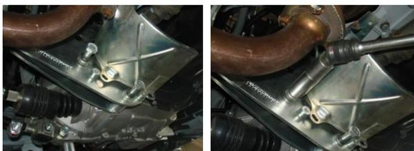
Установить кронштейн от Автопродукт, наживить все болты. Прикрутить заднюю опору двигателя к кронштейну и затянуть.
