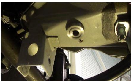
В базовое отверстие необходимо установить штифт.
