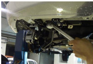
Открутить болты крепления передних кронштейнов
