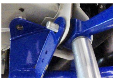
Сначала необходимо совместить отверстия задних охватывающих кронштейнов подрамника с отверстиями охватываемых кронштейнов. Штифты при этом должны войти в базовые отверстия. Для удобства можно поджать жесткий рычаг подрамника стойкой.
