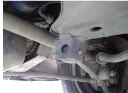
Удерживая накидным ключом 19 головку болта рычага, открутите накидным ключом 19 гайку и замените болт на более длинный из комплекта «AUTOPRODUCT». Аналогично замените болт с другой стороны, не выводя резьбовую часть за плоскость кронштейна рычага (см. рисунок).
