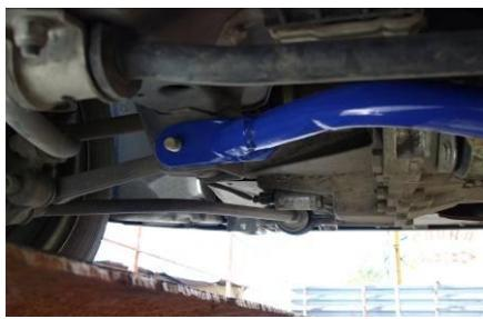
Наденьте проушины распорки на выступающую резьбовую часть болта.
