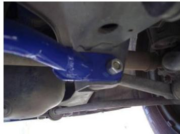
Накиньте гроверы и гайки на болты и произведите затяжку.
